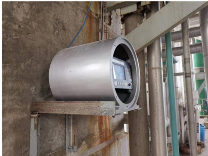
水中油在线分析仪：紫外荧光法测水体总含油量分析仪，可以满足水中油检测更广的现场应用需求。紫外荧光法测量水中油分子的浓度设计理念依据“HJ/T92—2002水污染物排放总量监测技术规范》石油类、动植物油监测方法的自动在线监测法为（红外法、荧光法）”，采用紫外荧光法测量水中油分子的浓度，油分子在特定紫外光照射下为激发态，这种激发态很不稳定，会很快返回到基态；在返回基态的过程中会有辐射荧光产生，而水样中的油分子浓度与发射出的辐射荧光强度成正比关系。利用矿物油/动植物油类受到紫外光激发会产生可见光波段的荧光特性，采用紫外荧光法制成的仪器对水中油有非常好的选择性。紫外荧光原理UV500UV400UV300都能使用紫外荧光法对水中油进行连续在线分析。
